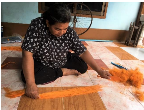
ภาพที่ 7 วิธีการเตรียมเส้นใยสับปะรดโดยการนำมาสาางเส้นใยด้วยหวี
